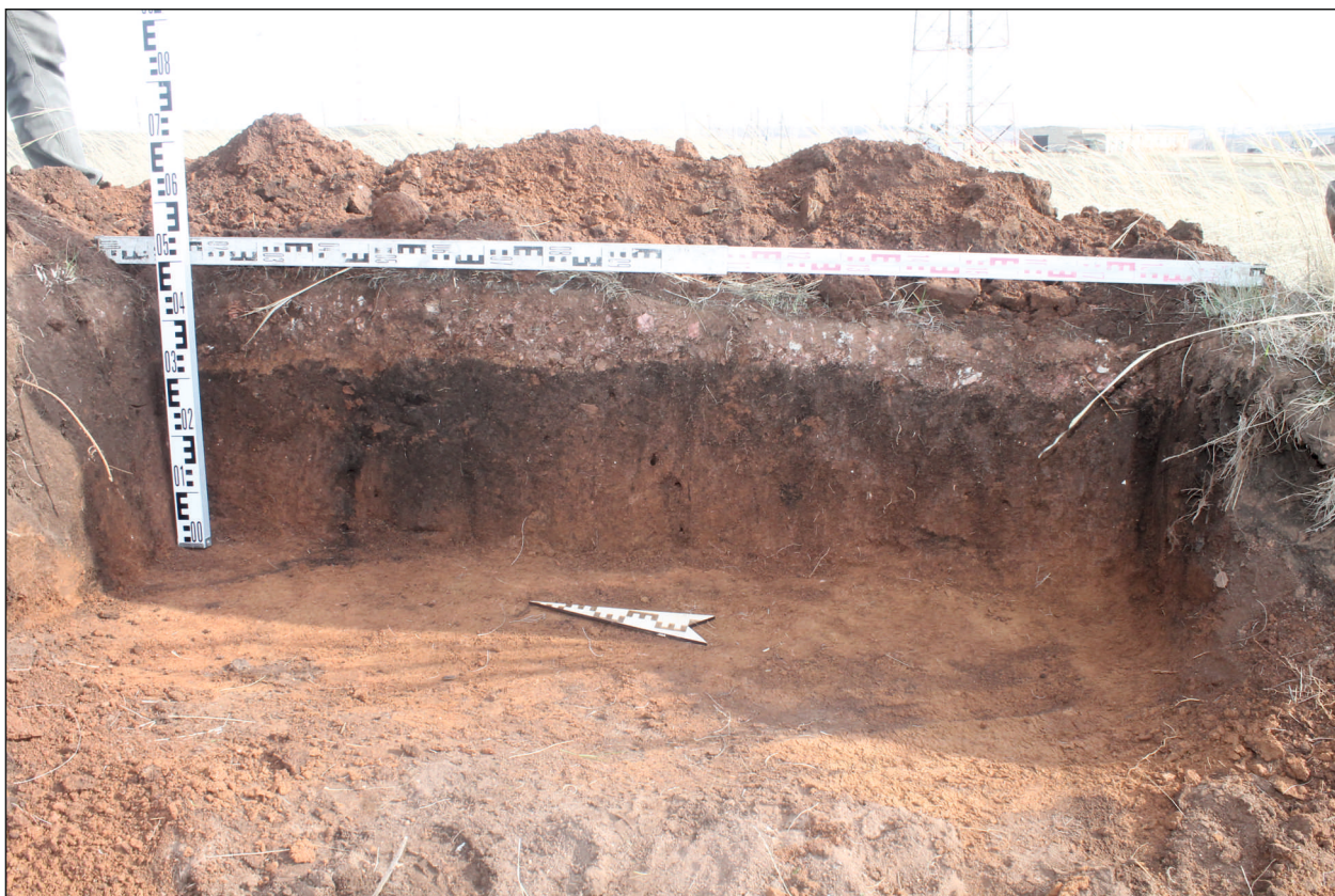
Рис. 19. Северный район. Земельный участок, отводимый под объект «Строительство автомобильной дороги Подъезд к с. Курская Васильевка от автомобильной дороги Секретарка – Дымка». Пункт фотографирования №3. Восточная стенка шурфа №2 (врезка). Фото с запада.
